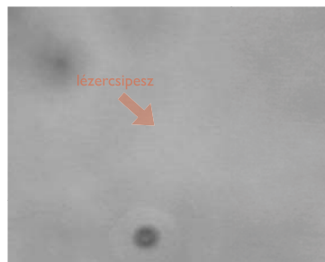
Hat folyadékban álló részecskékre (lézercsipeszben megragadott mikrogöngy)
