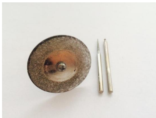
18. ábra A fog tisztításához és fúrásához használt fúrófejek (saját fotó)
