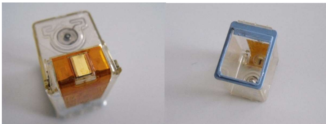
7. ábra A kitisztított, átalakított tinta patronok alul és felülnézeti képe
